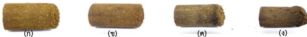
ภาพที่ 8 เชื้อเพลิงแข็งจากไบกาสะลอง เมื่อผสมกับกาวแบ่งเปียกในอัตราส่วนต่าง ๆ
