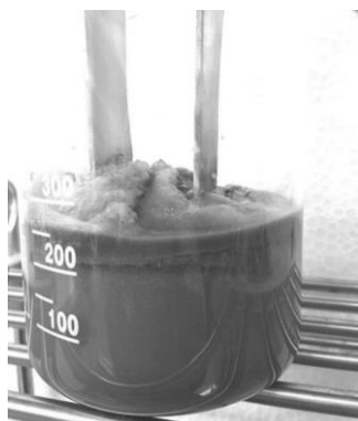
ภาพที่ 3: ตะกอนและฟองอากาศขณะทำการบำบัด
