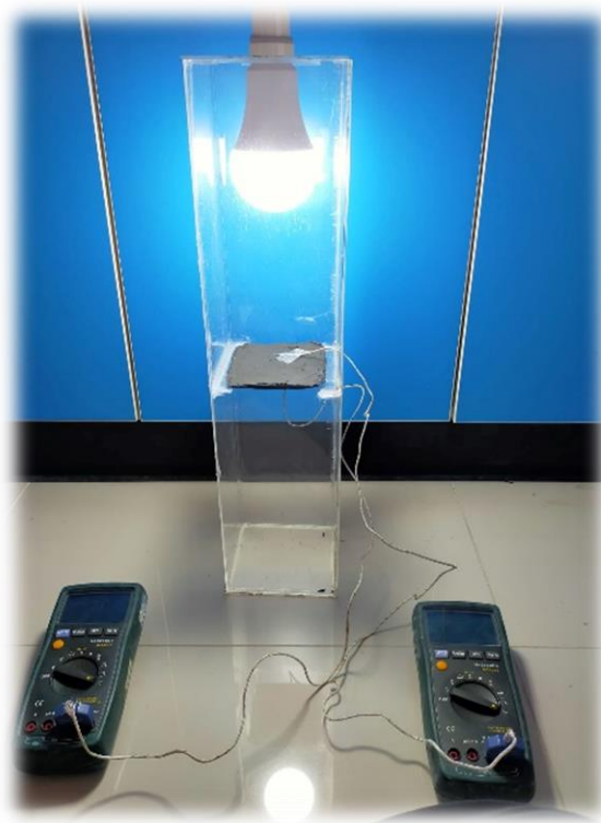
ภาพที่ 2 ตู้ทดสอบ (สภาพจริง) สำหรับทดสอบการป้องกันความร้อน
