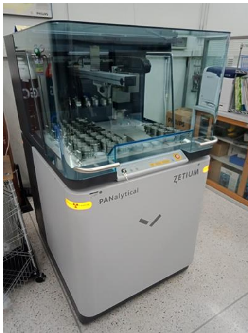
ภาพที่ 4 เครื่องเอกซเรย์ฟลูออเรสเซนแบบกระจายความยาวคลื่น
