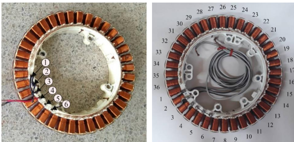
ภาพที่ 1: การดัดแปลงของมอเตอร์เครื่องซักผ้าเพื่อปรับปรุงกำลังไฟฟ้า
