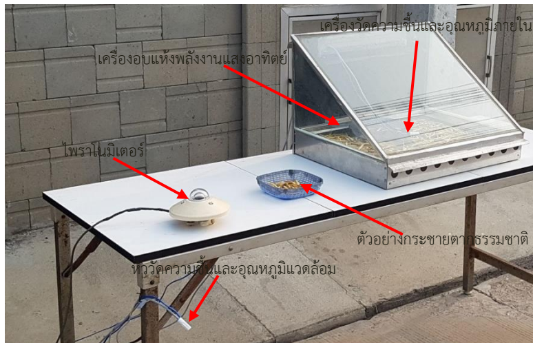
ภาพที่ 2 แสดงการติดตั้งเครื่องมือในการทดลอง
