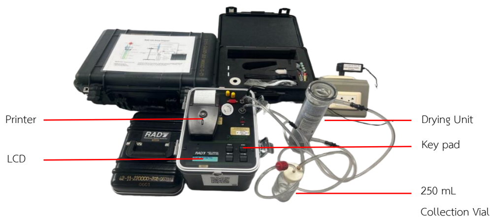
ภาพที่ 2 ระบบวัดความเข้มข้นแก๊สเรดอนในน้ำด้วยเครื่องวัด RAD7-RAD H 2 O
